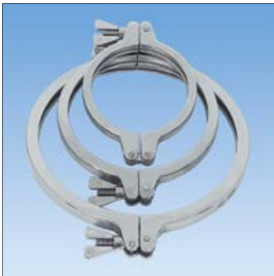
Gegossene Gelenkklemmen nach DIN und ISO Typ SH. Größen von 1/4" bis 6", DN 08 bis DN150. Edelstahl-Feinguss 1.4408 (AISI 316)
