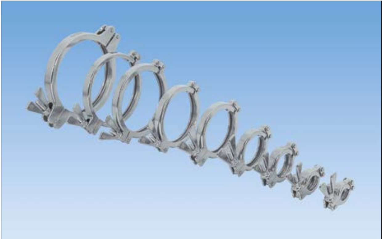
Gegossene Gelenkklemmen nach DIN und ISO Typ SH. Größen von 1/4" bis 6", DN 08 bis DN150. Edelstahl-Feinguss 1.4408 (AISI 316)
